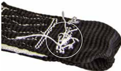
Coutures indicatrices cassées/endommagées - Mettre immédiatement hors service!
