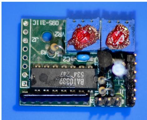
**FIG. 2. ORIGINAL LX200 CLASSIC MOTOR ENCODER BOARD.**
