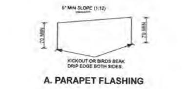
A. PARAPET FLASHING
