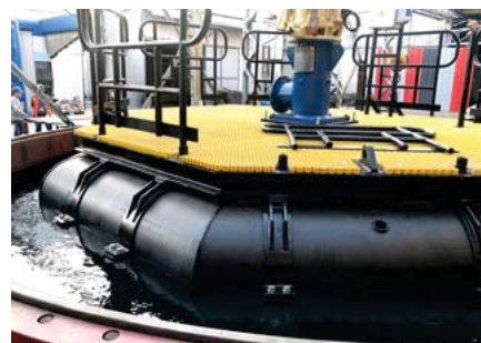
Bombas verticales sumergibles tipo turbina (VTP) Peerless, montadas sobre balsas flotantes para tranques de relave.
