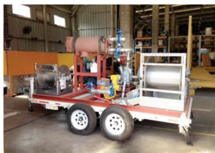
Sistema móvil de despacho de combustible, montado sobre carro de arrastre.
