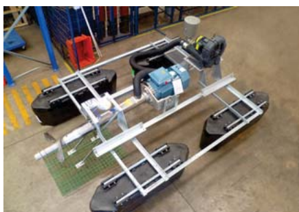
Sistema de aireación y agitación flotante para piscinas en plantas de tratamiento de aguas servidas.
