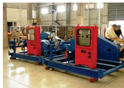
Plataformas con bombas de desplazamiento positivo y VDF para agua de sello National-Oilwell Varco (NOV).
