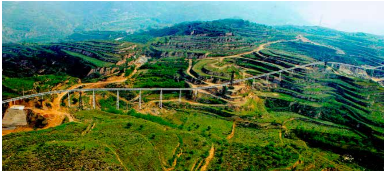
山西太钢集团石灰石运输管状带式输送机 Pipe conveyor for TISCO
