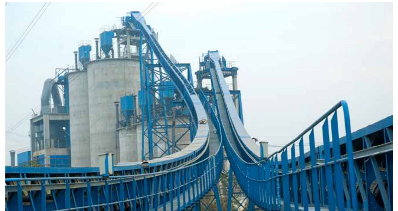
平顶山姚电水泥公司管带机 Pipe conveyor for Yaomen Cement Co. Ltd
