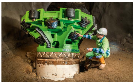
Cabeza escariadora en la unidad de perforación al comienzo de la perforación del pozo.
