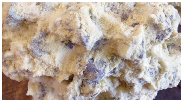
WEBAC® SILfill in Schotter
