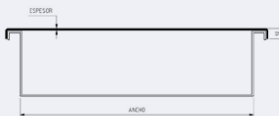
Tapa plana para Bandeja de pestaña ZR TP B G 2.0 Z AxL mm
