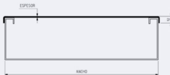
Tapa plana para Bandeja de pestaña CR TP B G 2.0 C AxL mm
