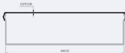
Tapa plana para Bandeja de pestaña VE TP B G 2.0 VI AxL mm
