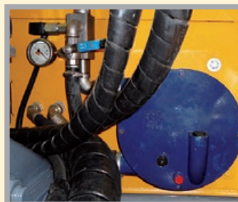
Bomba de aditivos líquidos sincronizada con el caudal de hormigón.
