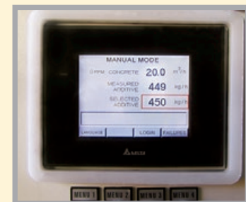
Sistema de control con display multilingüe a color, indica el caudal de hormigón, la dosificación de aditivos, fallos, diagnósticos y alarmas
