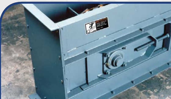
Tensor en la Sección de Cola de Transportador de Fondo Plano
