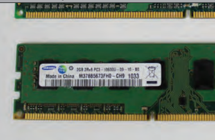
ElectriCorr VpCI-239 después de 90 horas de exposición a niebla salina
