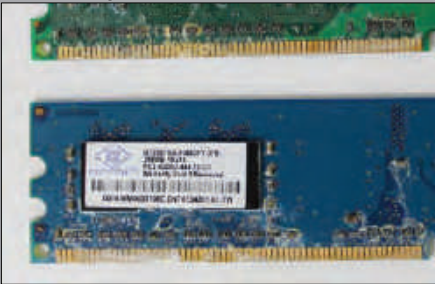
Control – Después de 90 horas de exposición a niebla salina
