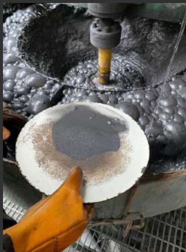
Flotación con DSP 1770
