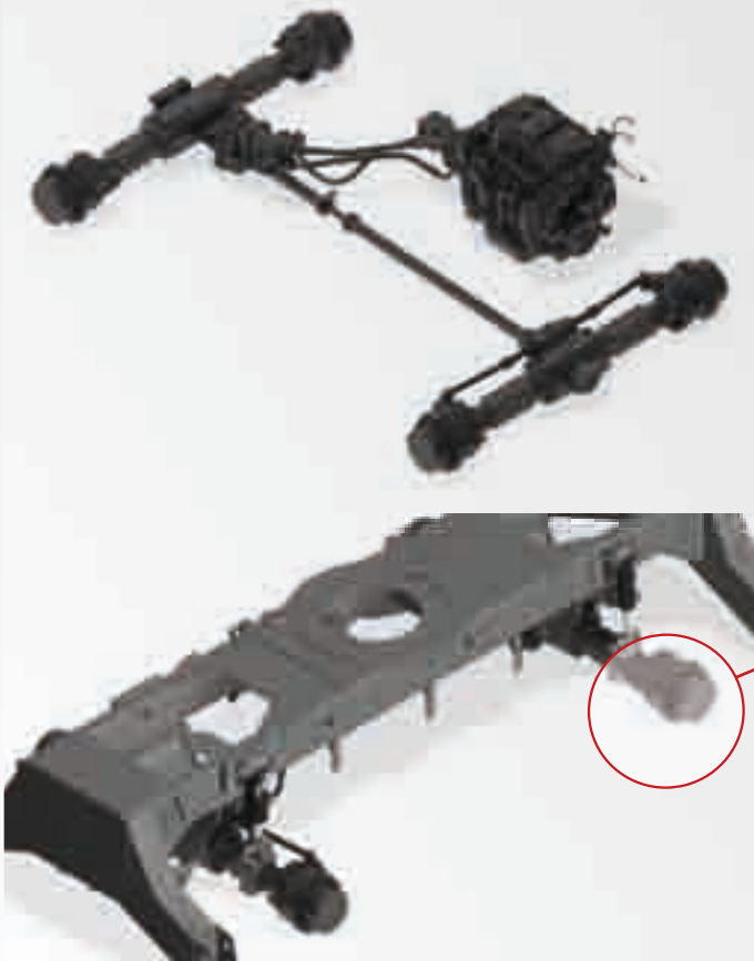
Engranaje de reducción epicicloidial y aceite de frenos inmersos en las 4 ruedas
