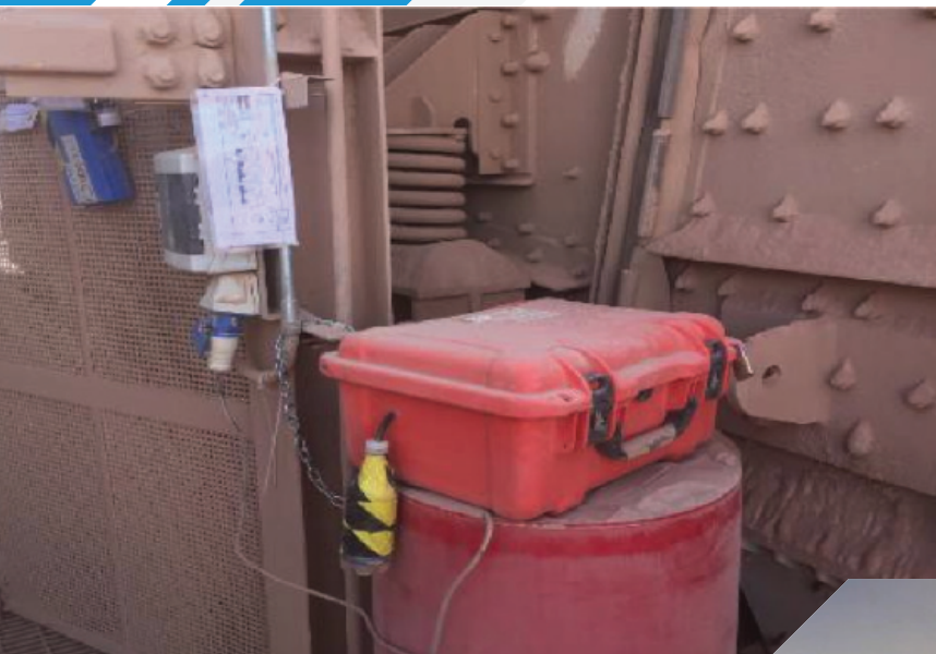
Red-Box®: monitoreo continuo de niveles extremos de polvo
