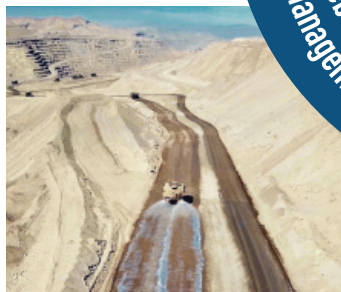
3) Sistemas de riego controlado y guiados por App móvil (Chancado, caminos, Botaderos, Frentes carguio)
