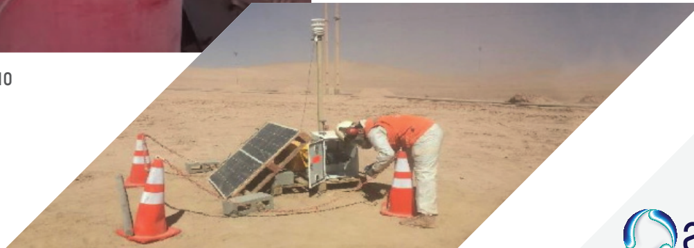
DMS-AQS ®: Estación de monitoreo ambiental y de calidad del aire
