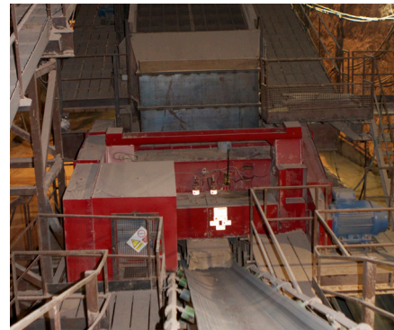
Los chancadores de rodillos dobles pueden instalarse por encima de la tierra o de forma subterránea.
