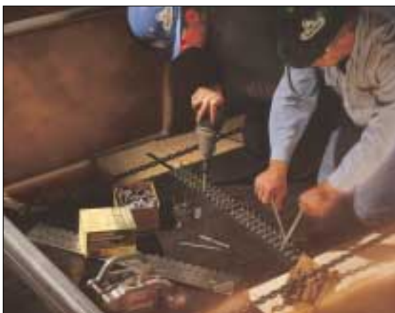
La instalación del empalme con grapas mecánicas es fácil y rápido utilizando herramientas comunes en el lugar, tomando una fracción de minuto del tiempo requerido por la vulcanización.
