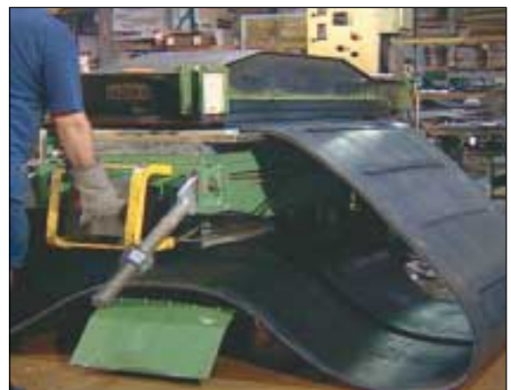
Adicionalmente a las prensas de calor, el empalme vulcanizado requiere conocimiento de solventes y otros químicos y además mayor tiempo para realizarlos.
