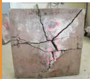
Imagen 11 (Arriba): Ensayo de panel EFNARC en base soportada continuamente.
