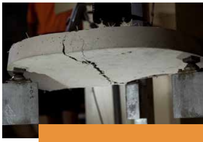
Imagen 14: Los puntos de apoyo a la medida del ensayo de fricción más baja y permitir un patrón de fisura repetible de 1200 mm de longitud, reduciendo así la variabilidad.
