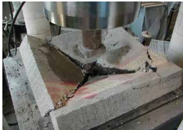
Imagen 11 (Arriba): Ensayo de panel EFNARC en base soportada continuamente.
