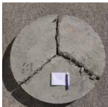
Imagen 14: Los puntos de apoyo a la medida del ensayo de fricción más baja y permitir un patrón de fisura repetible de 1200 mm de longitud, reduciendo así la variabilidad.
