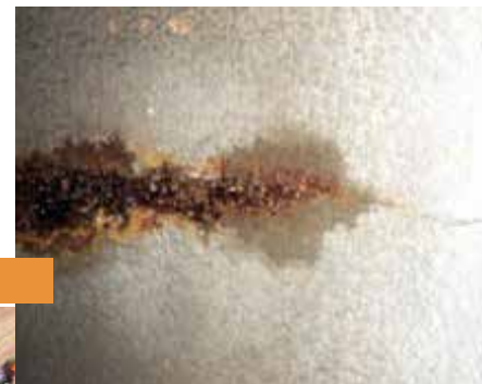
Imágen 3: Los efectos de corrosión y fragilización en la durabilidad del SFRS a largo plazo son severos.
