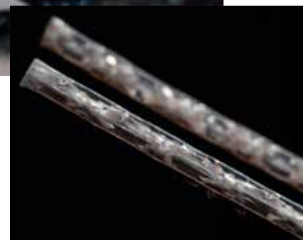
Imágen 4: MSF nunca sufrirá por corrosión y es la fibra preferida en entornos agresivos o donde se requiera una larga vida útil.
