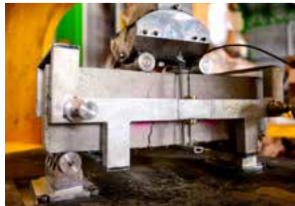
Imágen 10: El modo de fallo de la sección transversal de un ensayo típico realizado a una viga con una sola grieta no refleja el comportamiento de un revestimiento de concreto proyectado.
