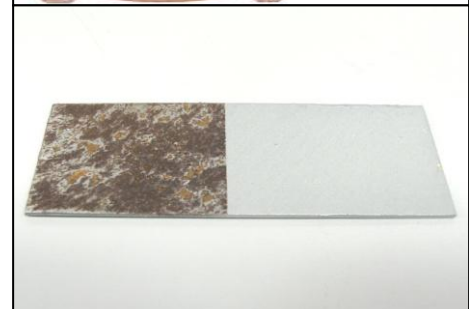
Prueba en ambiente marino en acción: En la parte derecha, se observa la fuerte resistencia de CORIUM 78 frente a la corrosión y la formación de herrumbre
