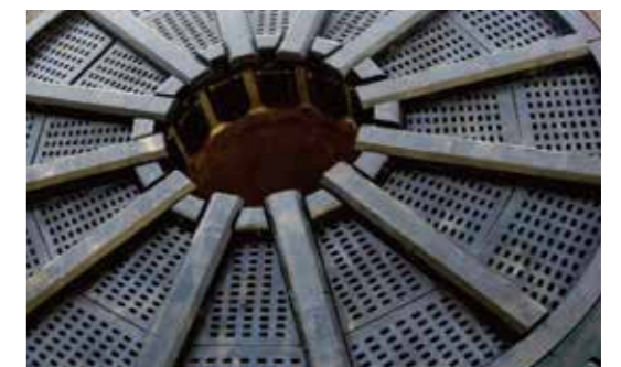
Parrillas de goma para tapa de descarga en molino de bolas \varnothing 3.2 \times 4.5\text{m}
