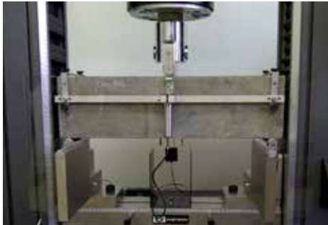
Imagen 6: Ensayo de viga entallada/mellada EN 14651
