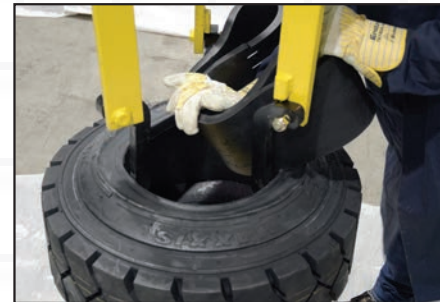
3. Insertar las capas de Soft Core en el neumático
