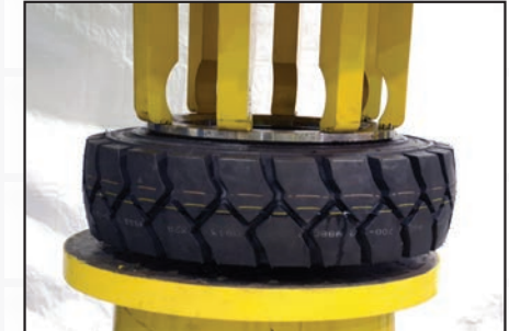
4. Colocar en la rueda a presión
