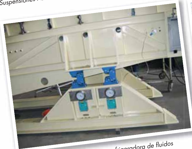
Suspensiones AB en criba para planta móvil de trituración
