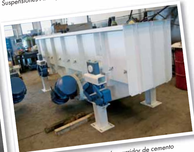
Suspensiones AB-D para bandeja refrigeradora de fluidos
