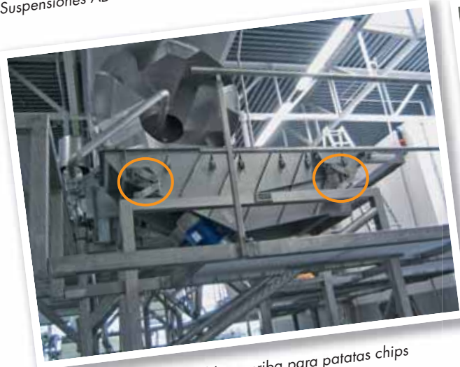
Suspensiones AB en alimentador para el lavado de legumbres
