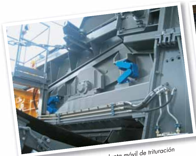
Suspensiones AB-D para bandeja refrigeradora de fluidos
