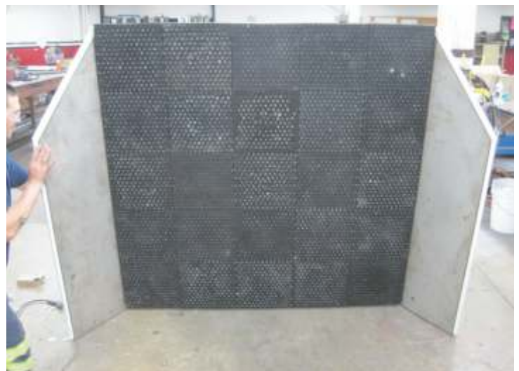
Campana revestida con X-Wear™ MDX en el centro y Nitronic SX en cada lado.
