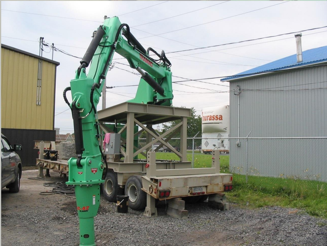
Pluma de 3 secciones montada en remolque
