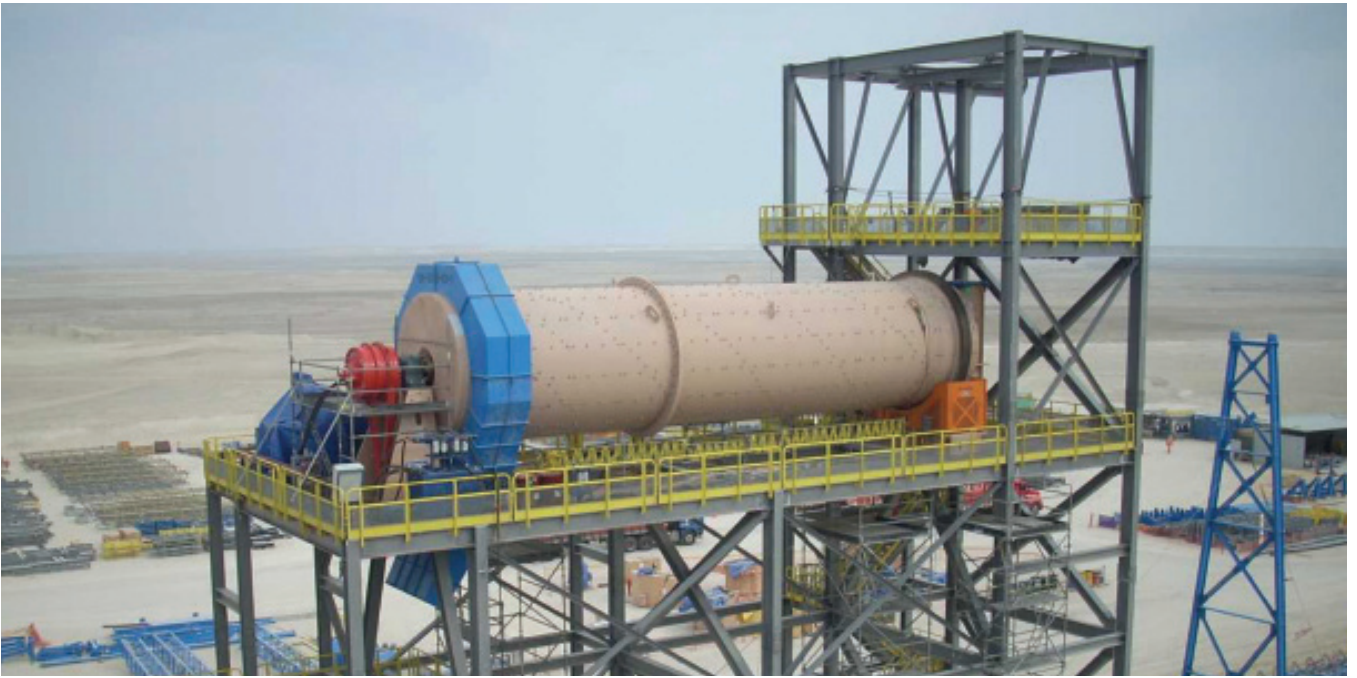
Tambor lavador rotatorio en aplicación de fosfato
