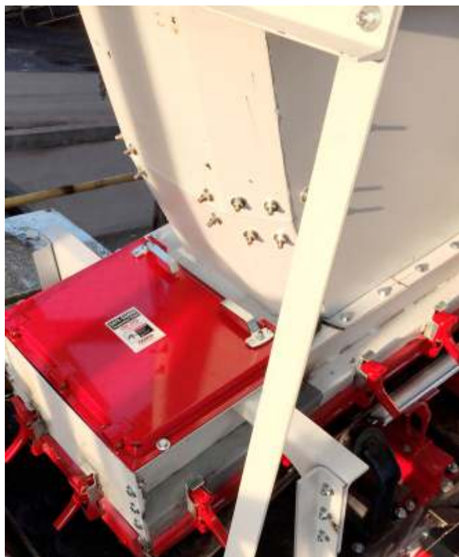
Caja de Cola de la transportadora para la rampa de transferencia
