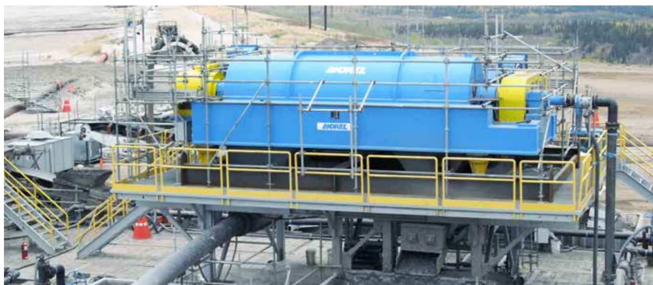
Centrífuga decantadora A14, la decantadora más grande que se haya vendido a nivel mundial
