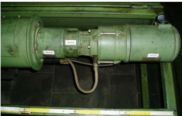
Antes: Tacógrafo DC con switch mecánico / Before: DC tachometer with mechanical switch
