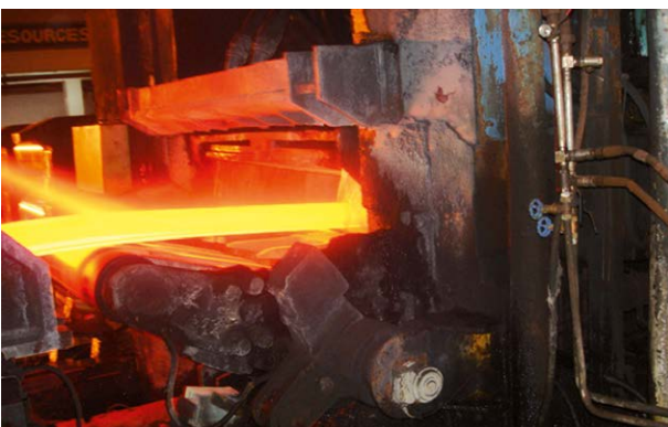
Antes: foso de bucles en caja de laminación / Before: Looper in roll stand
