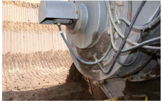
Posición de montaje en la rotopala / Mounting position at the bucket wheel
