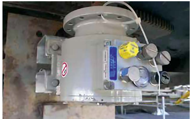
Después: medición de posición permanente con un encoder absoluto de seguridad certificada / After: Permanent position measurement with one safety-certified absolute encoder
