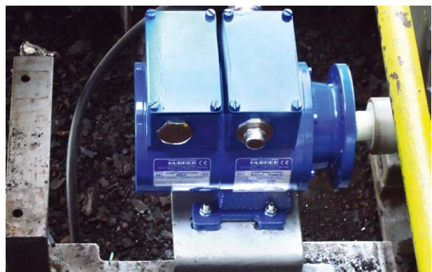
Después: ERC 40: switch de posición electrónico / After: ERC 40 - electronic position switch
