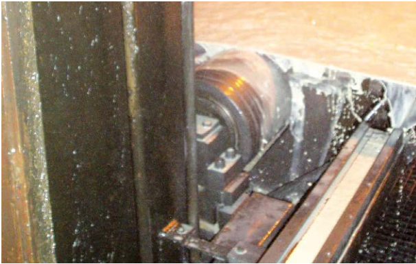
Antes: Medición de velocidad de la cinta de metal con baja confiabilidad por medio de utilización de láser / Before: Unreliable speed measurement of the metal strip with laser
