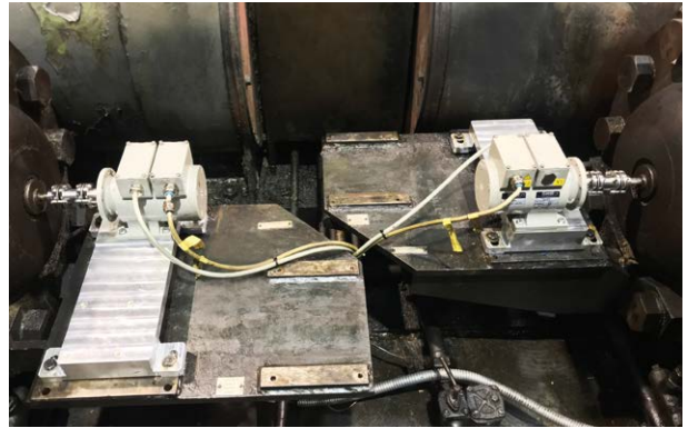
Después: ERC 40: Switches electrónicos de posición / After: ERC 40 – electronic position switches
