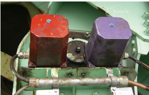
Antes: Switches de límite mecánicos / Before: Mechanical spindle limit switches
