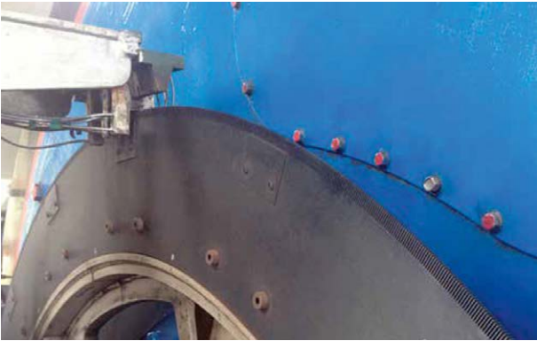
Antes: escaneado óptico de engranaje / Before: Optical tooth wheel scanning
