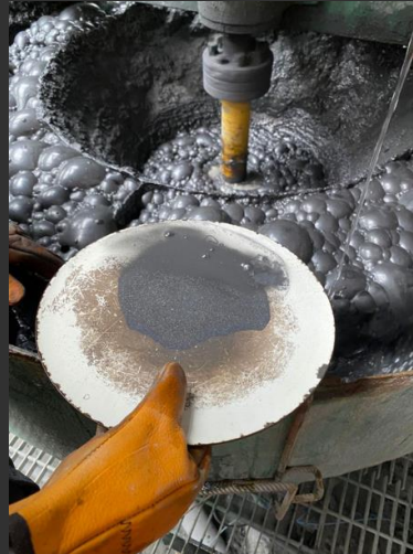
Flotación con DSP 1770
