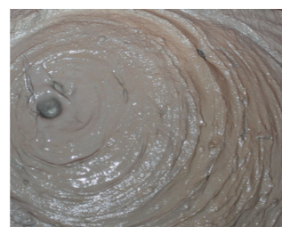
Caudal inferior del espesador desde un espesador de pasta de McLanahan.
