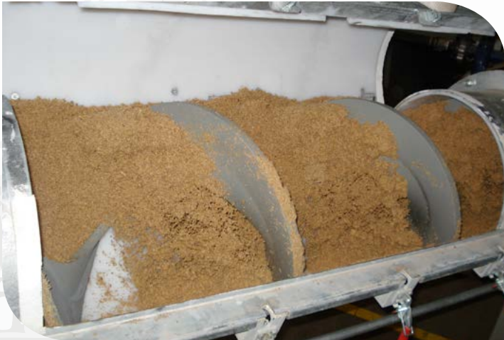
Helicoidal Shaftless con liner de UHMW transportando granos húmedos y pegajosos de cebada
