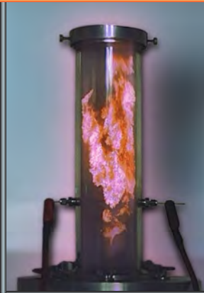
Prueba de Energía Mínima de Ignición (MIE) para Polvo de Carbón
