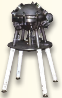
Recipiente de 20 litros utilizado para determinación de K_{ST} y P_{MAX}
