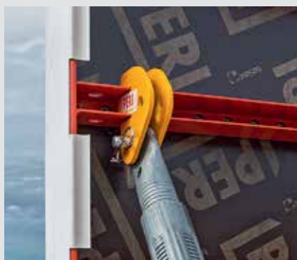
El conector de estabilizador LW simple para uso con paneles en posición vertical se fija con bulón y grupilla de seguridad en el travesaño de atado.
