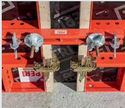
La correa de compensación para compensaciones hasta 25 cm con madera escuadrada y tablero de compensación.
