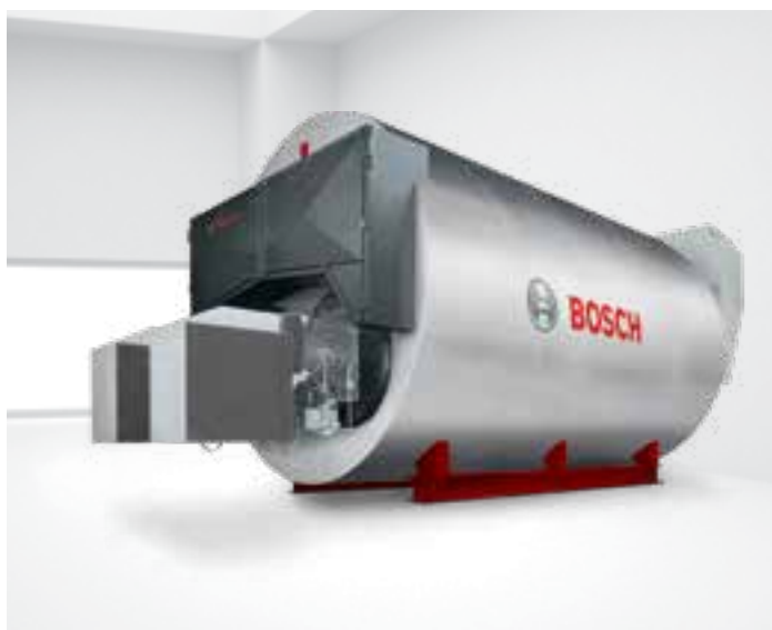
Serie UT-HZ , caldera pirotubular con dos hogares y tres pasos. Potencia entre 13.000 kW y 38.000 kW para agua sobrecalentada a alta presión.
