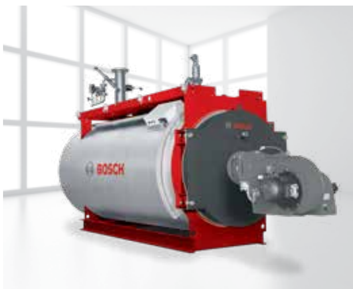
Serie UT-M , caldera pirotubular con un hogar y tres pasos. Potencia entre 650 kW y 19.200 kW para agua sobrecalentada a alta presión.
