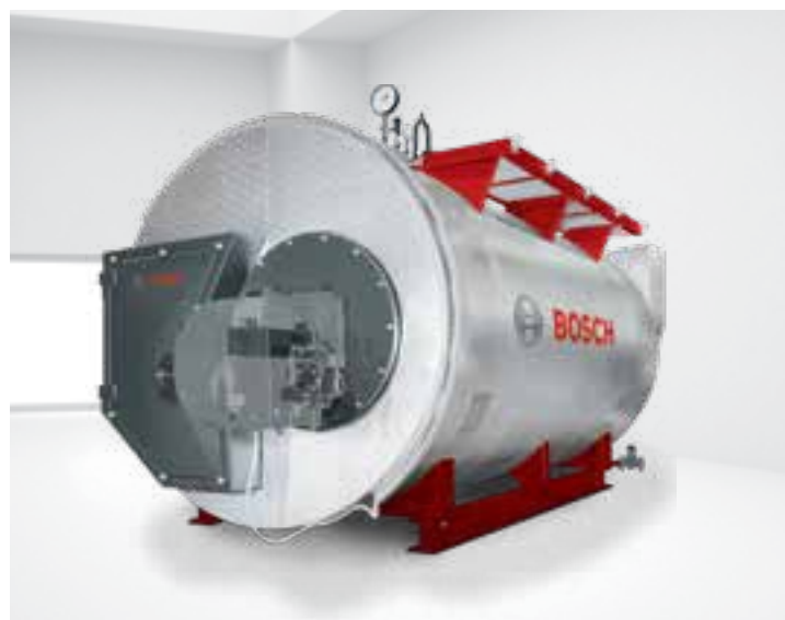
Serie UT-H , caldera pirotubular con un hogar y tres pasos. Potencia entre 650 kW y 18.300 kW para agua sobrecalentada a alta presión.
