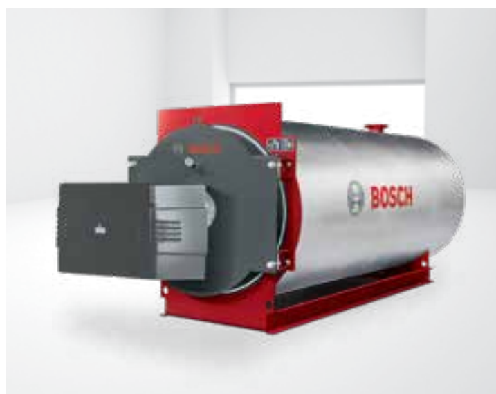
Serie UT-L , caldera pirotubular con un hogar y tres pasos. Potencias entre 650 kW y 19.200 kW para agua caliente a baja presión.
