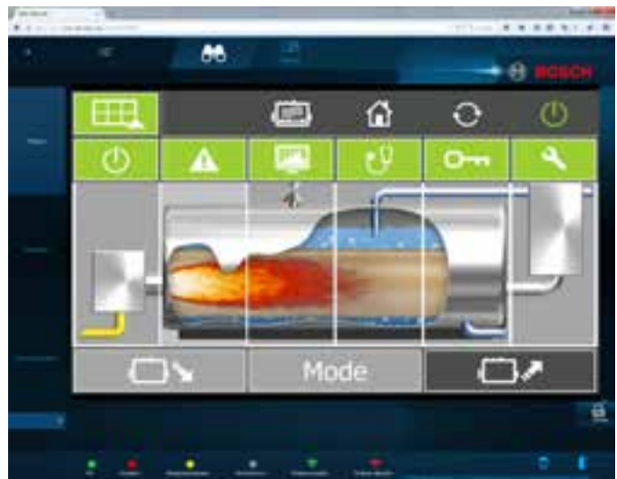
Acceso Remoto al control de la caldera
