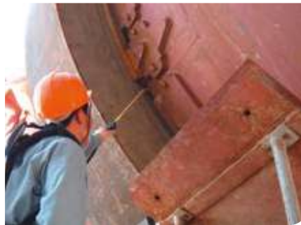
Cara interna de las ruedas flotantes del horno
