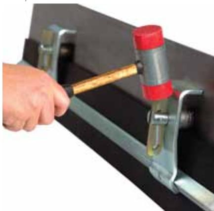
**Simplemente golpee ligeramente el pasador de bloqueo para volver a colocar o reemplazar el faldón de caucho y después golpear ligeramente para volver a bloquearlo en su lugar.**
