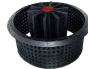
Rotor y estator de celda de flotación de 130m<sup>3</sup>
