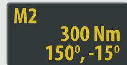
Procedimiento de torque/ángulo para conexiones de atornillado de alta calidad. Ejemplo de visualización de pre-torque, ángulo y ángulo de liberación.
