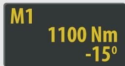
Atornillado mediante torque. Liberación automática según los grados de ángulo preestablecidos.
