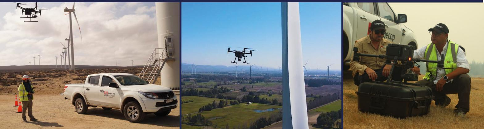
**Detección rápida de fallos:** Los drones permiten detectar incidencias estructurales en las palas de los aerogeneradores de manera rápida y segura. Gracias a cámaras de alta definición y otros sensores, pueden identificar problemas como corrosión o puntos calientes en tan solo minutos de vuelo.
