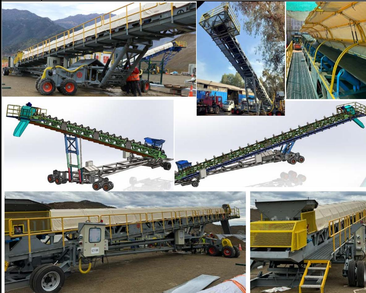
Equipos versátiles y multifuncionales que permiten el transporte y apilamiento de materiales. Cinta Transportadora fabricada en base a estructura reticulada de perfiles laminados, largo total y ancho de banda diseñados de acuerdo a los requerimientos del cliente.
