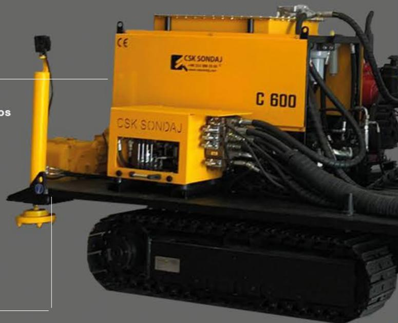
O suporte da haste abre hidráulicamente e fecha com pressão de gás. O suporte da haste e o mandril são sincronizados para eliminar erros humanos e eliminar o risco de queda das hastes
