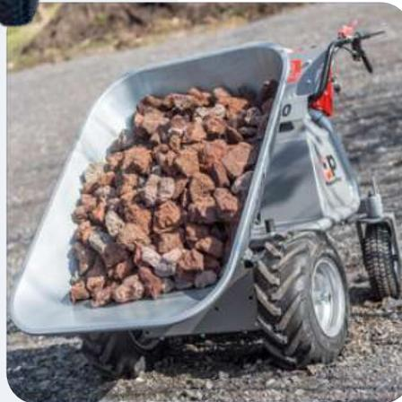
El ES-500 y el ES-800, dumper eléctrico compacto, son ideales para llevar cargas de hasta 500 kg y 800 kg respectivamente. Su diseño facilita el transporte y la maniobra en espacios reducidos. Además, con más de 8 horas de funcionamiento y alturas de descarga impresionantes, estos equipos son una solución segura y eficiente. Eleva tu productividad con nuestros equipos eléctricos de carga.
