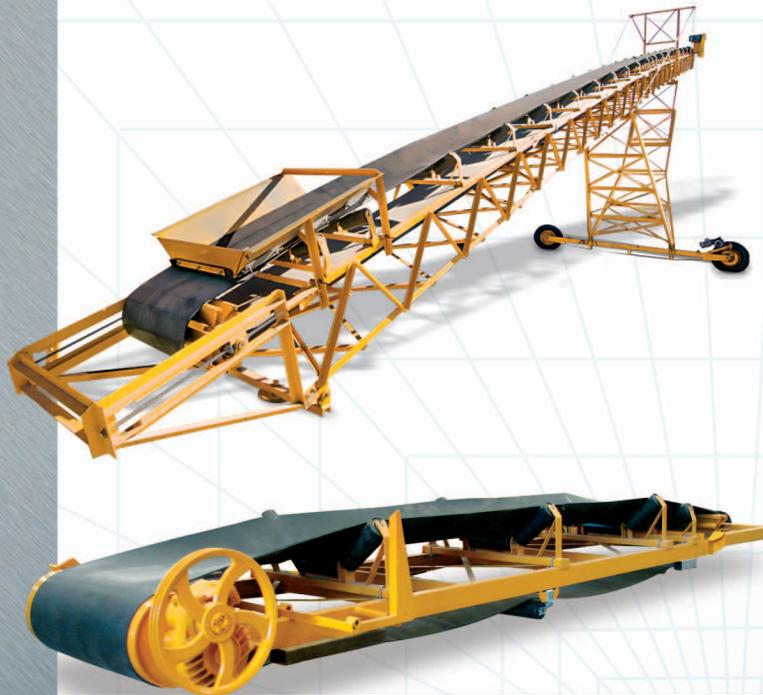
Las cintas transportadoras tienen la función de conducir o trasladar el material granular entre máquinas o formar pilas de acopio. Estos equipos consisten en una banda continua sin fin de tela y goma, ubicada por fuera de dos tambores. La cara superior (cara de carga) es soportada por rodillos ubicados a 1,2 mt. y la cara inferior (cara de retorno) es soportada por rodillos planos ubicados cada 3 mt.
