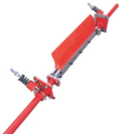
第一道初级清扫器(BK-PUR系列)结构简洁合理,具有抗冲击,耐磨损,抗腐蚀,易调整,不伤皮带等特点,清扫效果好,安装位置佳,适合冷热接头的输送带清扫器,特别适合含水量大,粘附性强的恶劣工况条件下的初级清扫,安装在头部滚筒附近。
