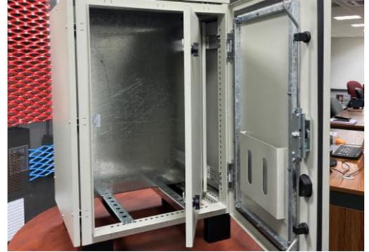
Producción de serie corta de gabinetes utilizados para contener tableros eléctricos utilizados en la minería
