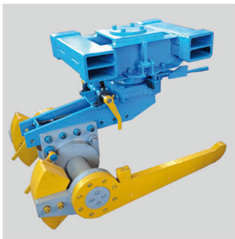
Manipulador de Anodos Equipo giroscopico utilizado en la manipulacion de anodos de cobre
