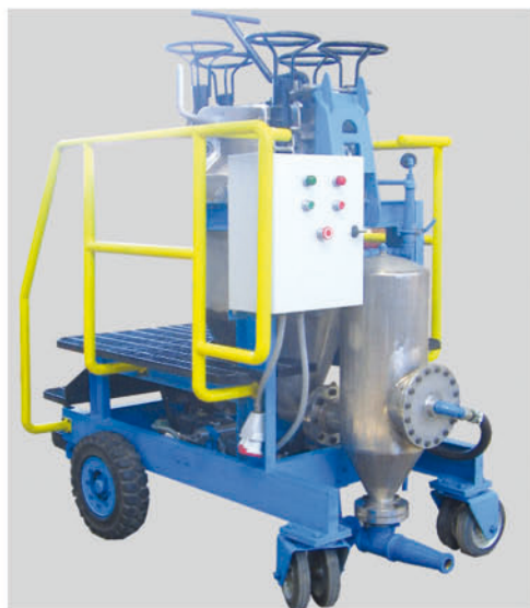
Equipo de Inyeccion de trioxido de Arsenico Opera en hornos de fundicion de cobre
