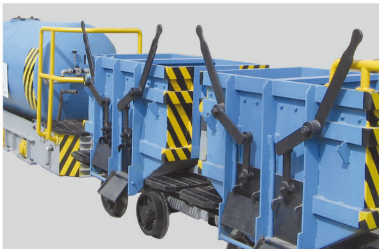
Locomotora para transporte de bolas de acero Equipo neumatico, utilizado en el transporte de bolas de acero
