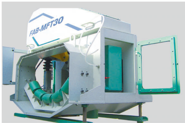
Muestreador de faja transportadora Equipos con accionamiento neumatico, toma muestras en fajas en movimiento
