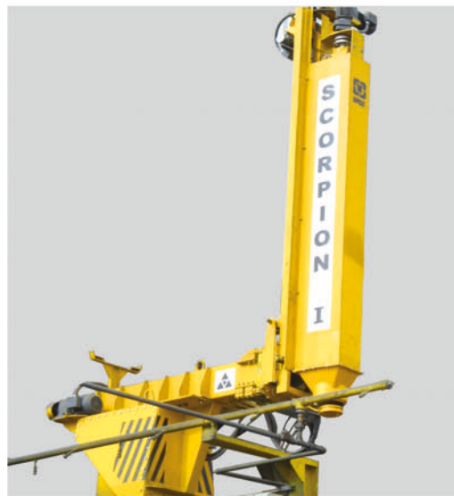
Automata muestreador de minerales Opera bajo las condiciones del entorno
