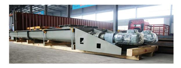
螺旋输送机可水平或倾斜布置,是一种利用电机带动螺旋回转,推移物料以实现输送目的的设备。
