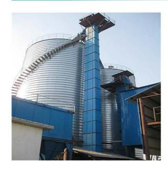
斗式提升机是一种固定装置的机械 输送设备,主要适用于粉状、颗粒状及 小块物料的连续垂直提升。
