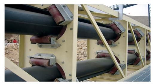
管状带式机是由呈六边形布置的托辊把胶带裹成边缘互相搭接成圆管状来输送物料的一种新型带式输送机。
