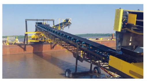
移动带式输送机底部安装有万向轮,可以根据物料的堆放位置随意移动,其高度可在规 定的范围内调节。
