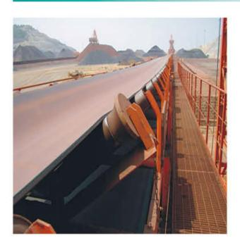
带式输送机是以输送带作牵引和承 载构件,通过承载物料的输送带的运动 进行物料输送的连续输送设备。
