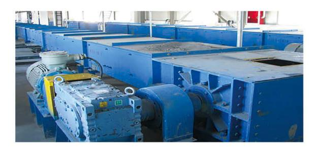
刮板输送机是借助于在封闭的壳体内运动着的刮板链条而使散体物料按预定目标输送的 运输设备。
