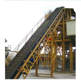
大倾角带式输送机主要用于散装物料的大倾角连续输送,采用具有波状挡边和横隔板的输送带,输送倾角为0~90度。
