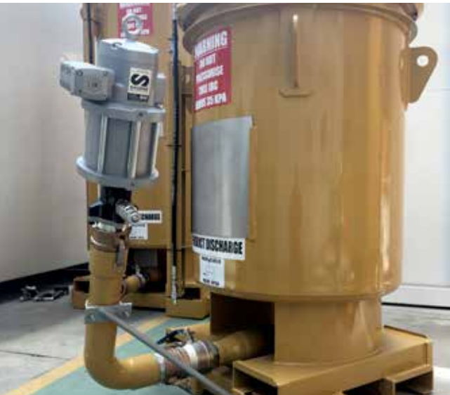
Montaje directo sobre tapa con plato seguidor
