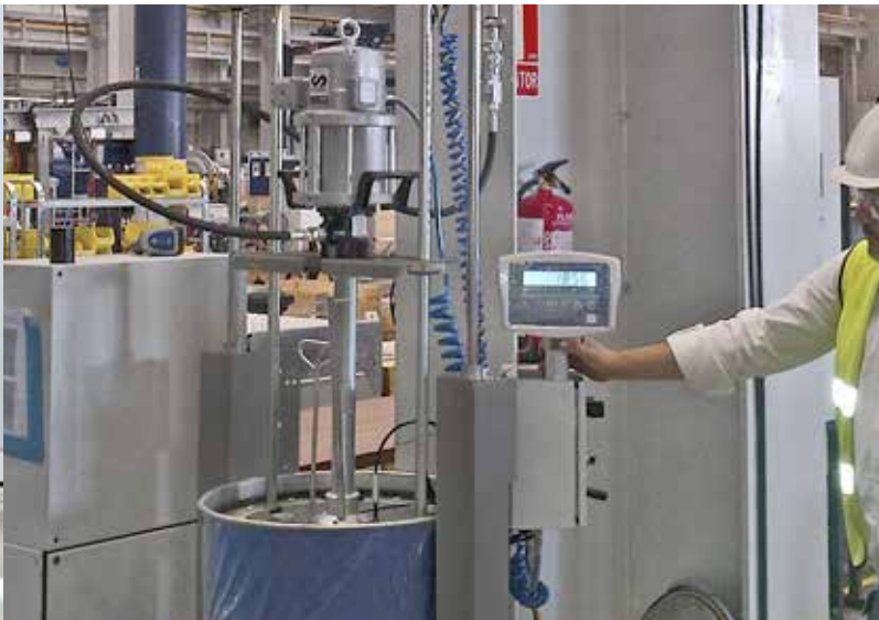
Montaje con inductor neumático
