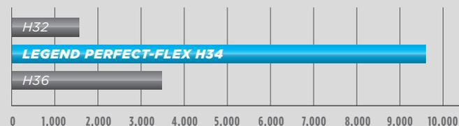
Lors des tests, l'aluminium H34 s'est avéré 2,5 fois plus fort que le H36, ce qui en fait le choix ultime et le plus robuste pour la fabrication de bateaux d'aluminium.
