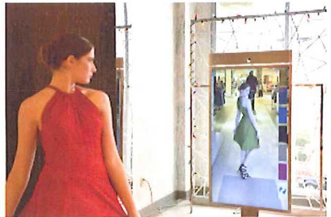
「メモリーミラー」はバーチャルで試着した衣服の色を変えることができる
